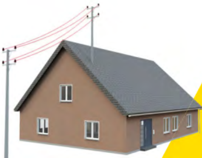
Haus mit Freileitungseinspeisung
