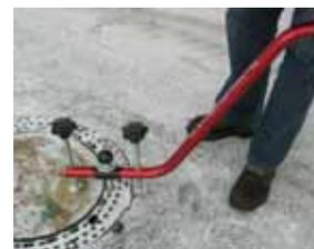
*Dazu wird der sechseckige Fuß außerhalb des Deckels platziert. Durch Nach-Unten-Drücken des Handgriffs wird der Deckel gelockert.*
