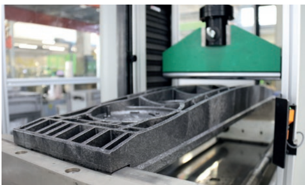
▲ 3-Punkt-Prüfpresse bei Langmatz in Oberau
