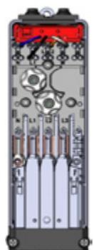
**Sicherungskasten EK480 G2S-2d mit ÜSS**
