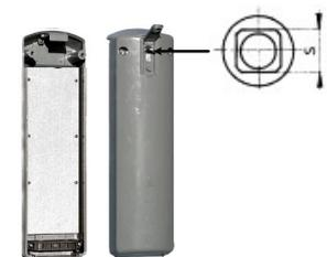
EK223 Rückwand geschlossen, ohne rückseitige Befestigungslaschen, Blindverschraubung PG21 von oben, mit Montageplatte 118x380x8, 2 Schrauben zur Befestigung am Ständer EK16, mit Zugentlastung für 3 Kabel, ohne Steckleisten, Einsteckboden offen montiert, Einsteckboden geschlossen im Beipack, Verschlusschraube Dreikant K1 10mm
